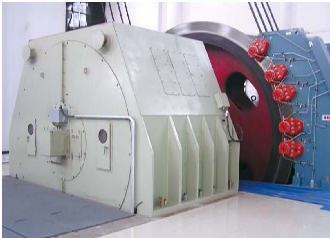
TDBS 5500-16 0-52.7r/min 3150V (长机座) 交流调速同步电动机在淮南矿业集团谢桥矿运行 Huinan Xieqiao Mining Ac synchronous motor TDBS 3200-16 1460V 0~68r/min
