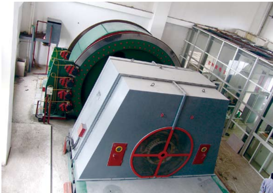
TDBS 4400-24 0-51r/min 1500V (短机座) 交流调速同步电动机在铜陵有色金属(集团)公司冬瓜山矿运行 AC speed synchronization of mine hoist TDBS 4400-24 1500V 0~51r/min, Anhui Tongling Nonferrous Metals Inc Dongguashan Mining.
