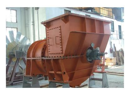
在国家积极发展绿色环保能源,着力提升节能减排水平的时代背景下,上鼓研制了适用于钢厂转炉炼钢干法除尘风机,此风机系统的耗电量及耗水量低至原来的1/3,满足了冶金行业降低能耗的需求,该产品对于用户发展绿色环保能源,提升节能减排能力具有积极的意义。
