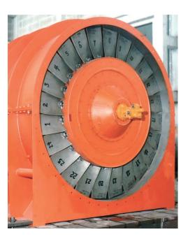
高温空气循环再热风机的作用是将炉 膛中的高温烟气抽出,并与冷一次风和送 风混合送入炉膛燃烧,有效提高了锅炉送 风温度,节省燃料,提高锅炉效率。
