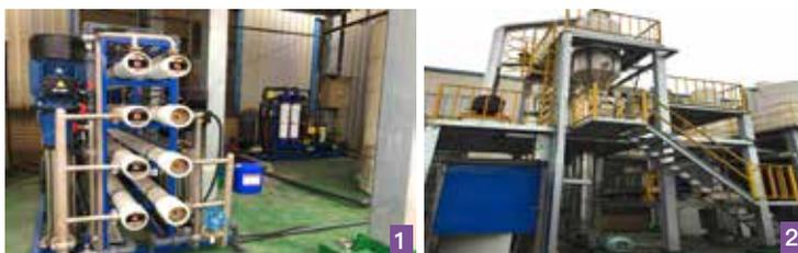
1. CFRO膜濃縮系統
