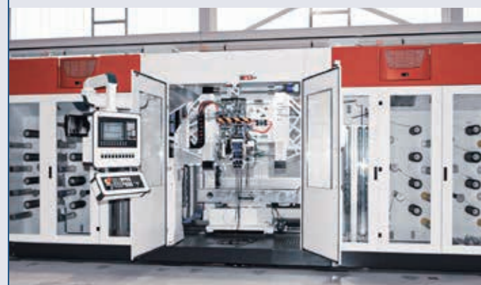
↑ 铺丝铺带机 ■ 高效铺放技术，高材料利用率
