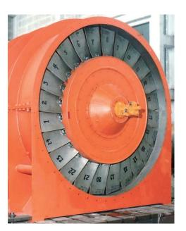
高温空气循环再热风机的作用是将炉 膛中的高温烟气抽出,并与冷一次风和送 风混合送入炉膛燃烧,有效提高了锅炉送 风温度,节省燃料,提高锅炉效率。
