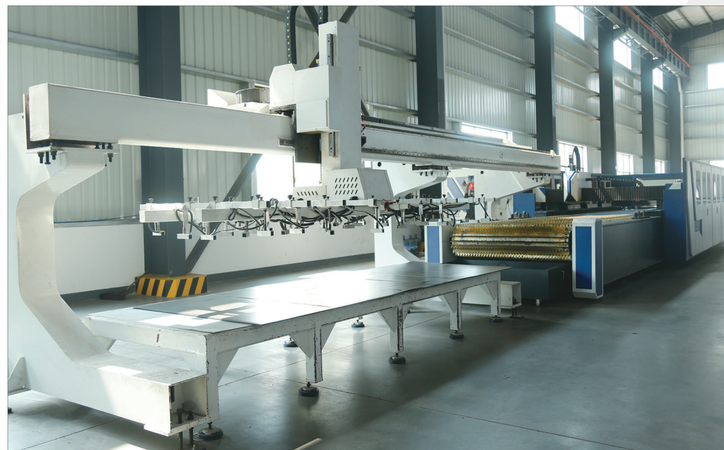
▼ 生产流水线 自主研发的风阀及风机 自动化下料生产流水线
