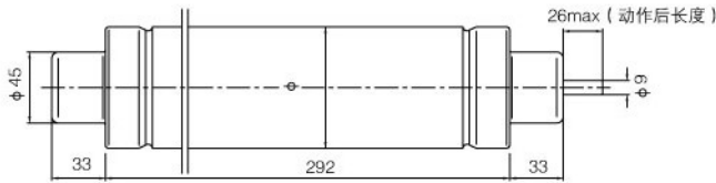
图1 熔断件外形尺寸和撞击器动作后尺寸
